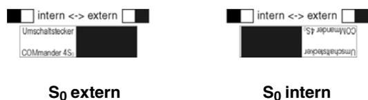
Abb. 7: Steckbrückenstellung am COMmander 4 $S_0$ -Modul (Rev. 3) und COMmander 8 $S_0$ -Modul
